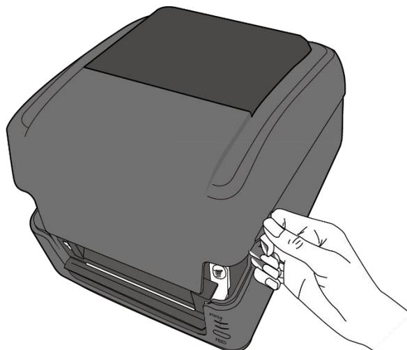
2. Presione el seguro de los **Soportes de Media** para deslizarlos hacia afuera y coloque el rollo de la media entre los soportes, ajuste el rollo de media de manera que el lado de impresión quede hacia arriba y asegúrese de que se encuentra ajustada entre los soportes.
