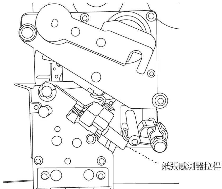
務必確認紙張感測器位置標示(Media sensor position mark)座落在標籤紙孔洞的正上方。
