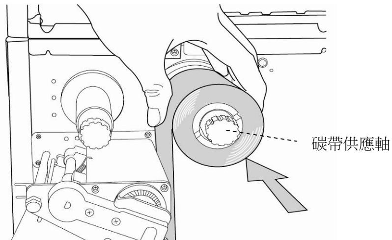
4. 將碳帶繞過印字頭模組下方。將碳帶前緣貼到碳帶捲筒，並將部分碳帶捲到捲筒上。確定將碳帶的碳粉層朝下。
