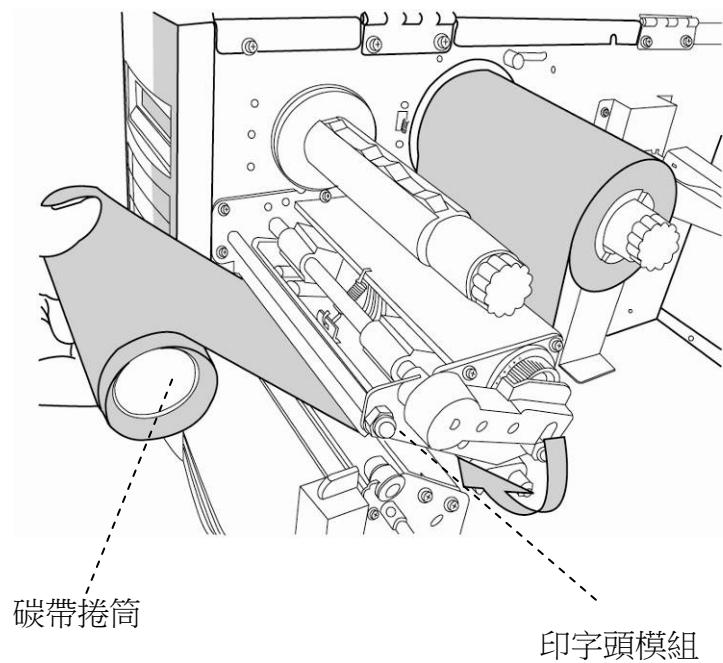
5. 將碳帶捲筒插入碳帶回收軸，轉動回收軸，拉緊碳帶。
