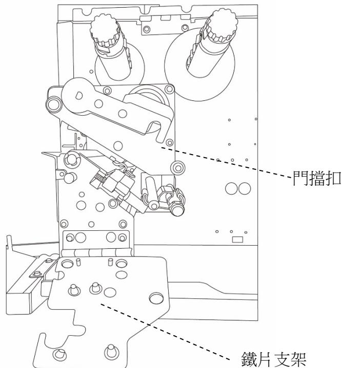
將紙張感測器拉桿往下拉，即可向左或向右調整紙張感測器模組位置。
