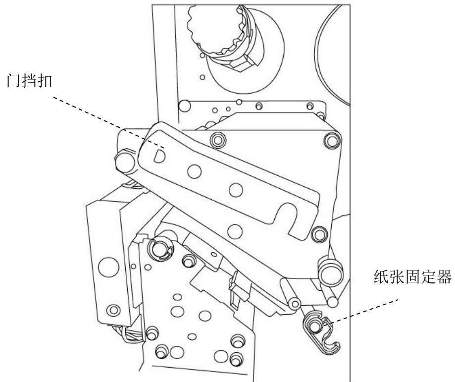
6. 关闭上盖，并开启打印机电源，或在打印机开机的情况下按下走纸键。接着
