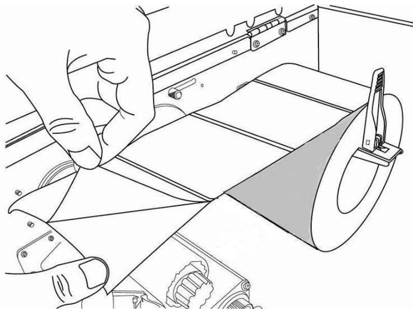
5. 将卷标底纸穿过打印头模块下方。
