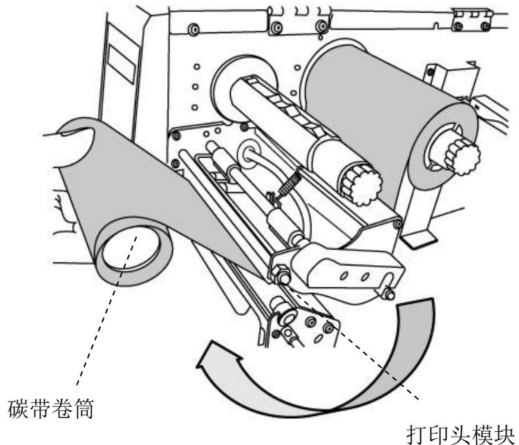
5. 将碳带卷筒插入碳带回收轴，转动回收轴，拉紧碳带。
