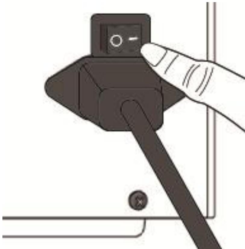
2. 确认、纸张和碳带指示灯会一齐亮，确认灯关闭期间 LCD 会显示韧体版本，之后 LCD 显示准备打印，三个灯号都会恒亮，开机完成。
