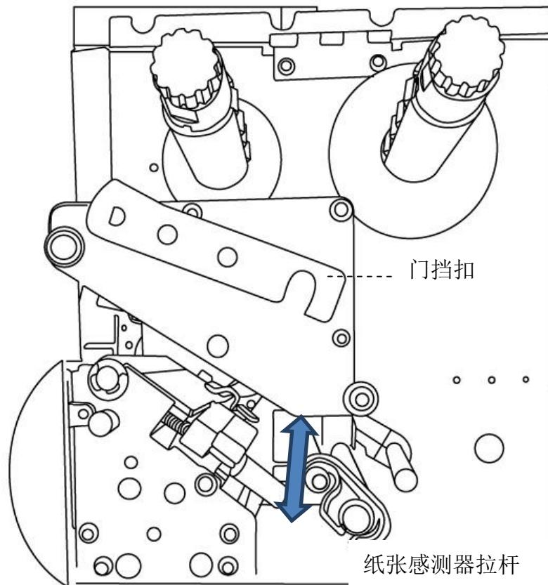
请务必确认纸张传感测器位置标示(Media sensor position mark)座落在标签纸孔洞的正上方。
