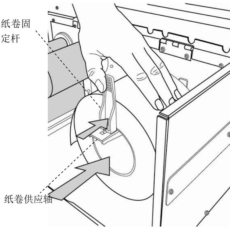
3. 逆时针转动门挡扣和纸张固定器。
