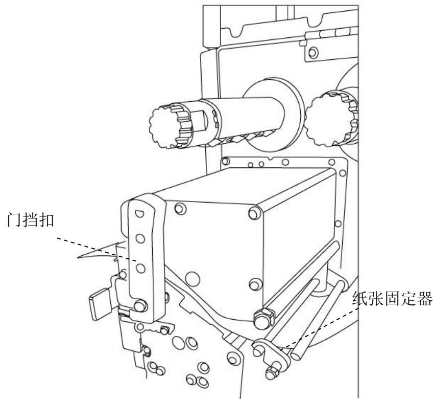
6. 关闭上盖，并开启打印机电源，或在打印机开机的情况下按下走纸键。接着打印机会自动将卷标送入裁纸器。
