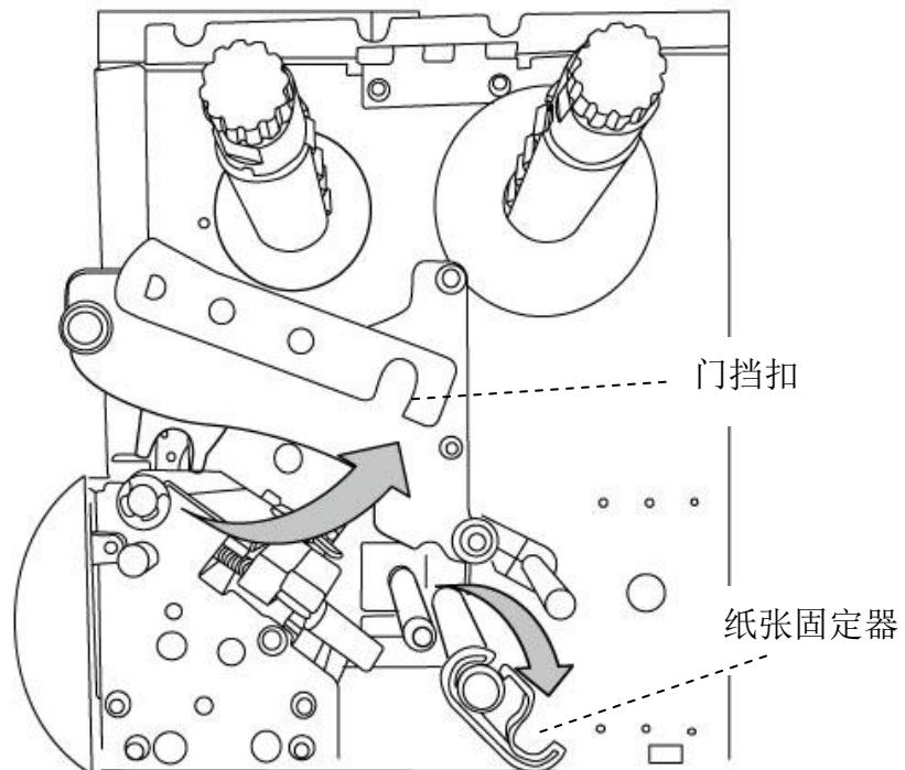
4. 将纸张穿过打印头模块下方，并穿过纸张感测器，将纸张放置于滚轴上方。
