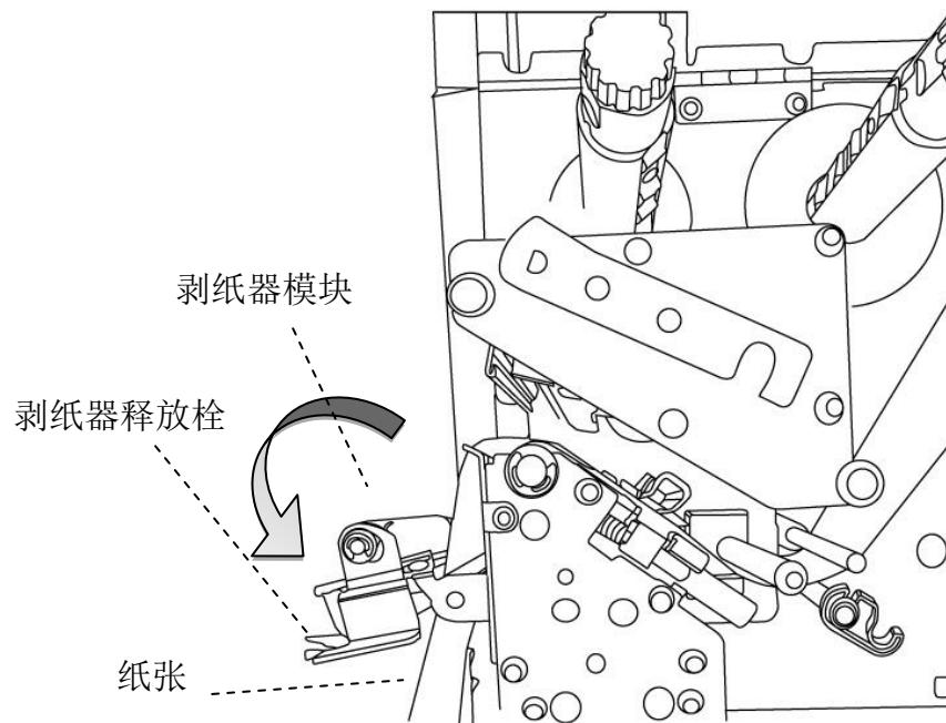
7. 关回纸张固定器并推至纸张边缘固定纸张，卡入门挡扣，使用剥纸器释放栓关上剥纸器模块。
