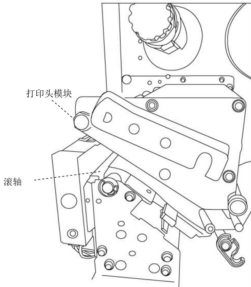
5. 将纸张固定器恢复原位，关上铁片支架，然后卡入门挡扣。
