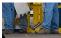
Resistencia a caídas: 1.5 metros sobre el hormigón
